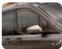
ClimAir®* Boczny deflektor wiatru do okien drzwi przednich, transparentny
