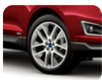
Jante de liga leve 20" 5 x 2 raios em Y, Polidas/Cavidades em Aço Inoxidável Escuro 8.5 x 20", offset 52.5, para pneus 255/45 R20
