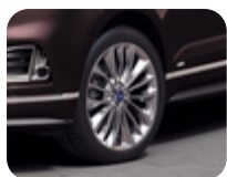
Jante de liga leve 20" 5 x 3 raios, em alumínio polido 8.5 x 20", offset 52.5, para pneus 255/45 R2
