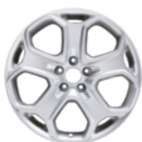
Jante de liga leve 18" design em Y de 5 raios, prateado 7,5 x 18", offset 52,5, para pneus 225/40 R18 – apenas em combinação com limitadores da caixa da direcção
