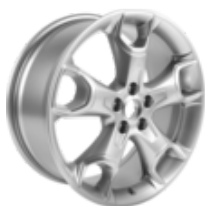
Jante de liga leve 19" de 5 raios em estrela, Luster Nickel 8 x 19", offset 52.5, para pneus 235/45 R19
