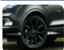
Jante de liga leve 19" 5 x 2 raios, cor preto Absolute 8 x 19", offset 52.5, para pneus 235/45 R19
