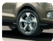
Jante de liga leve 18" 5 raios, prateado sparkle, maquinada 7.5 x 18", offset 52.5, para pneus 235/50 R18
