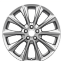
Jante de liga leve 19" 10 raios, polida 8 x 19", offset 52.5, para pneus 235/45 R19
