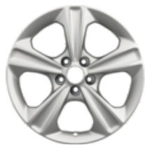
Jante de liga leve 17" Design de 5 raios, prateado brilhante 7.5 x 17", offset 52.5, para pneus 235/55 R17
