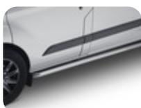
**ARP\* Faixa de proteção lateral aço inoxidável polido com design tubular e cantos curvilíneos**
