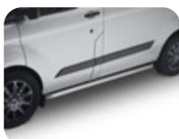
**ARP\* Faixa de proteção lateral em aço inoxidável polido com design tubular e cantos arredondados.**
