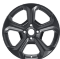
Jantă din aliaj 17" design 5 spițe, Rock Metallic 7 x 17", offset 47,5, pentru anvelope de 205/40 R17 – Numai în combinație cu ESP și limitatorul de cremalieră
