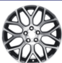
Jantă din aliaj 18" Design Y cu 8 spițe, negru finisat 8 x 18", offset (ET) 55, pentru anvelope 235/40 R18, numai împreună cu limitator de direcție – Cu excepția EConetic
