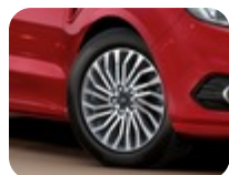
Jantă din aliaj 17" design cu 10 x 2 spițe, Gri perlă 7,5 x 17", ET 55, pentru anvelope 235/55 R17
