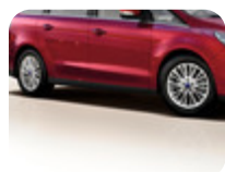
Jantă din aliaj 17" Design în formă de V cu 10 spițe, Argintiu Sparkle 7,5 x 17", offset 55, pentru anvelope 235/55 R17
