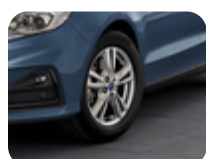
Jantă din aliaj 17" design V cu 5 x 2 spițe, argintiu strălucitor 7,5 x 17", offset 55, pentru anvelope 235/55 R17
