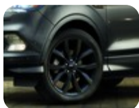
Jantă din aliaj 19" design cu 5 x 2 spițe, Negru Absolut 8 x 19", offset 52,5, pentru anvelope de 235/45 R19
