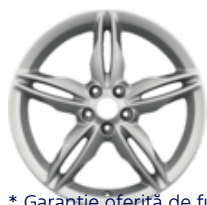
Jantă din aliaj 19" design 5 x 2-spițe, argintiu finisat 8 x 19", offset 52.5, pentru anvelope 235/45 R19
