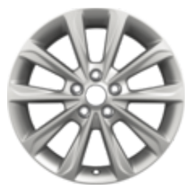
Jantă din aliaj 17" design cu 5 x 2 spițe, sparkle silver 7,5 x 17", offset 52,5, pentru anvelope 235/55 R17
