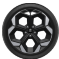
Roată completă de iarnă cu jantă din aliaj ușor 18" Design cu 5 spițe, Absolute Black 7J X 18 ET 47,5, Semperit SPEED-GRIP 5, 215/50 R18 92V, etichetă pentru caracteristicile anvelopelor conform directivei UE nr. 2020/740 – Cu senzori de monitorizare a presiunii în anvelope.
