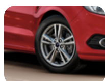
Jantă din aliaj 17" design V cu 2 spițe, argintiu strălucitor 7,5 x 17", offset 55, pentru anvelope 235/55 R17
