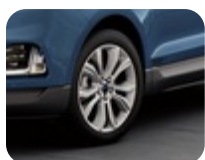
Disk z ľahkej zliatiny 19" 5 x 2-lúčový, strieborný 8 x 19", ET 52,5, pre pneumatiky 235/55 R19 – okrem Vignale
