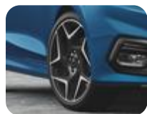
Disk z ľahkej zliatiny 18" 5 x 2-lúčový, strieborný 7.5 x 18", ET 42.5, pre pneumatiky 205/40 R18 – ST
