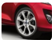
Disk z ľahkej zliatiny 17" 8-lúčový, strieborný 7 x 17", ET 47,5, pre pneumatiky 205/45 R17 – Okrem Active a ST
