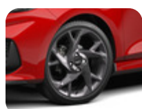
Disk z ľahkej zliatiny 18" 5-lúčový, matný 7 x 18", ET 42.5, pre pneumatiky 205/40 R18 – ST-Line
