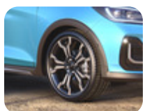
Disk z ľahkej zliatiny 18" 5 x 2-lúčový, čierny 7x 18", ET 42,5, pre pneumatiky 205/40 R18 – Active
