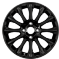
Disk z ľahkej zliatiny 16" 12-lúčový, čierny 6,5 x 16", ET 47,5, pre pneumatiky 195/45 R16 a 195/50 R16
