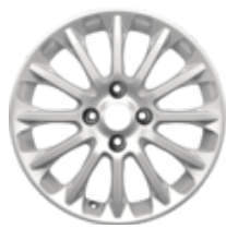
Disk z ľahkej zliatiny 16" 12-lúčový, strieborný 6,5 x 16" ET 47,5 pre pneumatiky 195/50 R16 a 195/45 R16
