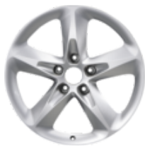
Disk z ľahkej zliatiny 16\" 5-lúčový, strieborný 7 x 16", ET 50, pre pneumatiky 205/55 R16
