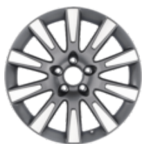
Disk z ľahkej zliatiny 17\" 10-lúčový, strieborný 7 x 17 ", ET 50, pre pneumatiky 205/50 R17
