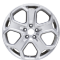
Disk z ľahkej zliatiny 18\" 5-lúčový tvaru Y, strieborný 7,5 x 18", ET 52,5, pre pneumatiky 225/40 R18 – iba v kombinácii s obmedzovačom hrebeňovej tyče riadenia
