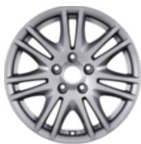
Disk z ľahkej zliatiny 16\" 7 x 2-lúčový, strieborný 7 x 16", ET 50, pre pneumatiky 205/55 R16
