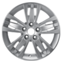
Disk z ľahkej zliatiny 16\" 5 x 3-lúčové, strieborný 6,5 x 16\", ET 50, pre pneumatiky 215/60 R16 – od 2006 onwards
