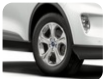
Disk z ľahkej zliatiny 17" 5-lúčový, strieborný 7 x 17", ET 50, pre pneumatiky 225/65 R17
