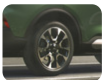
Disk z ľahkej zliatiny 19" 5 x 2-lúčový dizajn, čierny 7.5 x 19", offset 50, pre pneumatiky 225/55 R19.
