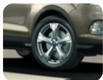
Disk z ľahkej zliatiny 18\" 5 ľúčový, strieborný 7,5 x 18", ET 52,5, pre pneumatiky 235/50 R18
