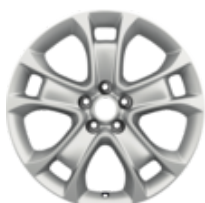
Disk z ľahkej zliatiny 18\" 5 x 2-ľúčový, šedý 7,5 x 18" ET 52,5, pre pneumatiky 235/50 R18
