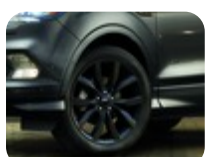
Disk z ľahkej zliatiny 19\" 5 x 2-ľúčový, čierny 8 x 19", ET 52,5, pre pneumatiky 235/45 R19
