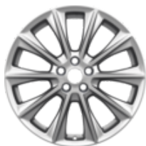
Disk z ľahkej zliatiny 18\" 10-ľúčový, strieborný 7,5 x 18", ET 52,5, 235/50 R18
