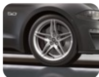
Disk z ľahkej zliatiny 19" 5 x 2-lúčový, strieborný 9 x 19", ET 45, pre pneumatiky 255/40 R19
