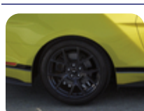
Disk z ľahkej zliatiny 19" zadný, sivý 10 x 19", ET 52.5, pre pneumatiky 275/40 R19
