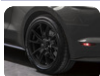
Disk z ľahkej zliatiny 19" 5-lúčový, čierny, zadný 9.5 x 19", ET 52.5, pre pneumatiky 275/40 R19
