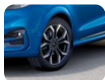
Disk z ľahkej zliatiny 18" 5 x 2-lúčový, Matt Black Machined 7 x 18", ET47.5, pre pneumatiky 215/50 R18 – Okrem ST a ST X
