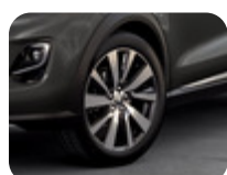
Disk z ľahkej zliatiny 18" 5 x 2-lúčový, Pearl Grey Machined 7 x 18", ET47.5, pre pneumatiky 215/50 R18 – Okrem ST a ST X
