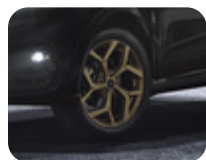
Disk z ľahkej zliatiny 18" 5 x 2- lúčový, Aurora Gold 7 x 18", ET 47.5, pre pneumatiky 215/50 R18 – ST-Line
