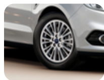
Disk z ľahkej zliatiny 17" 10-lúčový, strieborný 7,5 x 17", ET 55, pre pneumatiky 235/55 R17
