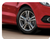
Disk z ľahkej zliatiny 17" 5 x 2-lúčový, strieborný 7,5 x 17", ET 55, pre pneumatiky 235/55 R17
