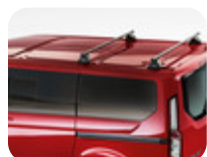
MontBlanc®* Základný strešný nosič základná súprava Sada 2ks, môže sa kombinovať s doplnkovou sadou, váha 4 kg, nosnosť 100kg – Pre vozidlá s nízkou strechou, okrem Nugget
