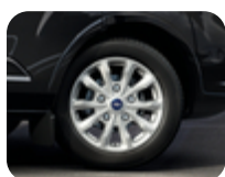
Disk z ľahkej zliatiny 17" 10-lúčový, strieborný 7 x 17", ET 55, pre pneumatiky 235/55 R17 alebo 215/60 R17
