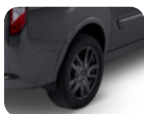
Disk z ľahkej zliatiny 18" 5 x 2-lúčový, šedý 7,5 x 18", ET 56, pre pneumatiky 235/50 R18 – Sport Van
