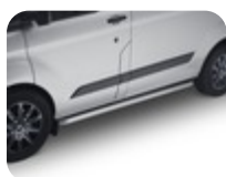
ARP* Bočný ochranný rám leštená rúrková konštrukcia z nerezovej ocele
