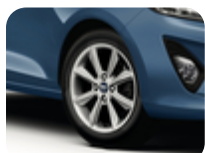
Lättmetallfälg 16" 8-ekrad design, Sparkle Silver 6,5 x 16", inpressning (ET) 47,5, för däck 195/55 R16
