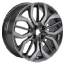
Lättmetallfälg 18" 5 x 3-ekrad design, Pearl Grey 7 x 18", inpressning (ET)47,5, för däck 205/40 R18 – ST-Line
