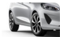
Lättmetallfälg 16" 8-ekrad design, Rock Metallic Machined 6,5 x 16", inpressning (ET)47,5, för däck 195/55 R16 – Passar ej Active eller ST
