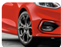
Lättmetallfälg 17" 5 x 2-ekrad Y- design, Rado Grey 7 x 17", inpressning (ET) 47,5 för däck 205/45 R17 – Passar ej Active och ST
