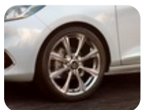
Lättmetallfälg 18" 8-ekrad design, polerad 7 x 18-tum, ET 42,5, för däck 205/40 R18. – Passar ej Active och ST
