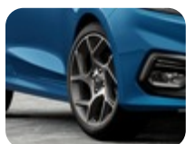
Lättmetallfälg 17" 5 x 2-ekrad Y-design, Flash Grey 7,5 x 17", inpressning (ET) 42,5, för däck 205/45 R17 – ST
