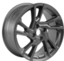
Lättmetallfälg 17" 5 x 2-ekrad design, Magnetite Machined 7 x 17", inpressning (ET) 42,5, för däck 205/45 R17 – ST
