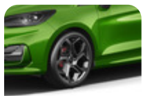
Lättmetallfälg 18" 5-ekrad Y-design, Magnetite Matt 7,5 x 18", inpressning (ET) 42,5, för däck 205/40 R18 – ST
