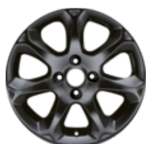
Lättmetallfälg 16" 7-ekrad design, Panther Black 6,5 x 16", inpressning (ET) 41,5, för däck 195/45 R16
