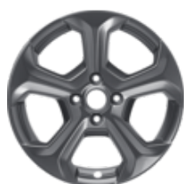
Lättmetallfälg 17" 5-ekrad design, Flash Grey 7 x 17", inpressning (ET) 47,5, för däck 205/40 R17 – Endast i kombination med elektroniskt stabiliseringsprogram (ESP) och utslagsstopp för styrväxeln
