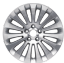
Lättmetallfälg 17" 15-ekrad design, silver 7 x 17", inpressning (ET) 50, för däck 205/50 R17
