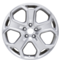
Lättmetallfälg 18" 5-ekrad Y-design, silver 7,5 x 18", inpressning (ET) 52,5, för däck 225/40 R18
