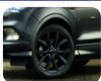
Lättmetallfälg 19" 5 x 2-ekrad design, Absolute Black 8 x 19", inpressning (ET) 52,5, för däck 235/45 R19
