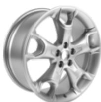
Lättmetallfälg 19" 5-ekrad stjärnmönster, Luster Nickel 8 x 19", inpressning (ET) 52,5, för däck 235/45 R19
