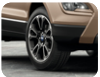
17" Alüminyum Alaşım Jant 10 kollu tasarım, Premium İşlenmiş Flaş Gri 7 x 17", offset 37.5, 205/50 R17 lastikler içindir.
