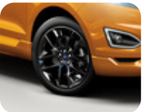
20" Alüminyum Alaşım Jant 5 x 2 kollu Y tasarım, lekeli koyu 8.5 x 20", offset 52.5, 255/45 R20 lastikler içindir – Vignale hariç
