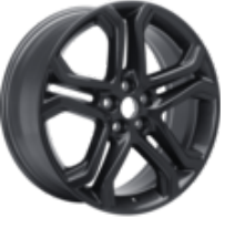
19" Alüminyum Alaşım Jant 5x2 Kollu Tasarım, Premium Alüminyum Boya 8 x 19", offset 52.5, 235/55 R19 lastikler için – Vignale hariç
