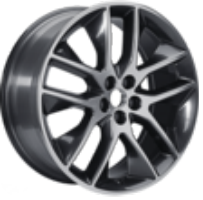
20" Alüminyum Alaşım Jant 5x2 Kollu tasarım, Paslanmaz Siyah 8.5 x 20", offset 52.5, 255/45 R20 lastikler içindir. Takma işlemi için ek parçalar gerekir. Ayrıntılı bilgi için Ford Yetkili Servisine başvurunuz. – Vignale hariç
