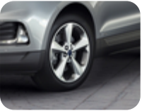
19" Alüminyum Alaşım Jant 5 kollu tasarım, parlak gümüş 8 x 19", offset 52.5, 235/55 R19 lastikler içindir – Vignale hariç
