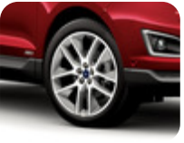
20" Alüminyum Alaşım Jant 5 x 2 kollu Y tasarım, cilalanmış gümüş 8.5 x 20", offset 52.5, 255/45 R20 lastikler içindir – Vignale hariç
