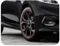
17" Alüminyum Alaşım Jant 5x2 Kollu Y tasarım, Kırmızı Halka Vurgulu Siyah 7 x 17", offset 47.5, 205/45 R17 lastikler için – Active ve ST hariç
