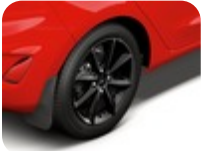
16" Alüminyum Alaşım Jant 8 kollu tasarım, siyah 6.5 x 16", ofset 47.5, 195/55 R16 lastikler için – Active ve ST hariç
