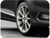
17" Alüminyum Alaşım Jant 10 kollu tasarım, parlak nikel 7 x 17", ofset 47.5, 205/45 R17 lastikler için – Active ve ST hariç
