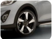
17" Alüminyum Alaşım Jant 5 Kollu Tasarım, İnci Siyah 7 x 17", ofset 42.5, 205/45 R17 lastik için – Active
