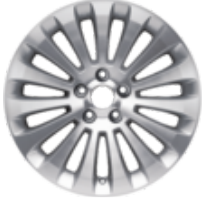
17" Alüminyum Alaşım Jant 15 kollu tasarım, gümüş 7 x 17", ofset 50, 205/50 R17 lastikler için
