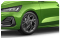
18" Alüminyum Alaşım Jant 5 kollu tasarım, Manyetit 8 x 18", ofset 55, 235/40 R18 lastikler için, sadece fabrikada takılan 18" jantlı araçlar için (direksiyon sınırlayıcı standart olarak takılır) – Active hariç
