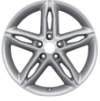
17" Alüminyum Alaşım Jant 5 kollu premium tasarım, gümüş 7 x 17", ofset 50, 215/50 R17 lastikler için
