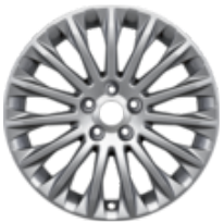
17" Alüminyum Alaşım Jant 15 kollu tasarım, gümüş 7 x 17", ofset 50, 215/50 R17 lastikler için
