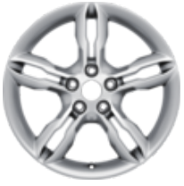
17" Alüminyum Alaşım Jant 5 x 2 kollu tasarım, parlak nikel 7 J x 17, ofset 50, 215/50 R17 lastikler için
