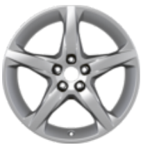
18" Alüminyum Alaşım Jant 5 Kollu Tasarım, Gümüş 8 x 18", ofset 55, 235/40 R18 lastikler içindir. Yalnızca direksiyon kremayer sınırlayıcı ile birlikte kullanılabilir.
