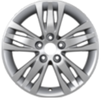
16" Alüminyum Alaşım Jant 5 x 3 kollu tasarım, Gümüş 7 x 16", ofset 50, 205/55 R16 ve 215/55 R16 lastikler için – ST ve RS hariç
