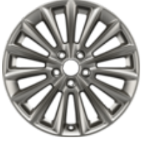
17" Alüminyum Alaşım Jant 15 kollu tasarım, İşlenmiş Koyu Gri 7 x 17", ofset 50, 215/50 R17 lastikler için – RS hariç
