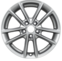
16" Alüminyum Alaşım Jant 5 x 2 kollu tasarım, gümüş 7 x 16", ofset 50, 205/55 R16 veya 215/55 R16 lastikler için
