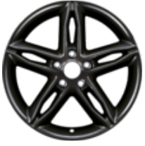
17" Alüminyum Alaşım Jant 5 x 2 Kollu Tasarım, İnci Siyah 7 x 17", ofset 50, 215/50 R17 lastikler içindir. – RS hariç
