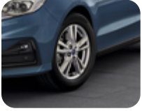
17" Alüminyum Alaşım Jant 5 x 2 kollu tasarım, parlak gümüş 7.5 x 17", offset 55, 235/55 R17 lastikler içindir.
