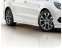
18" Alüminyum Alaşım Jant 5 Kollu tasarım, İşlenmiş Metalik Kaya 7.5 x 18", offset 55, 235/50 R18 lastikler için
