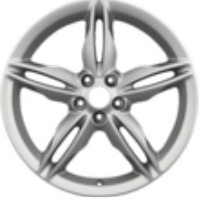
19" Alüminyum Alaşım Jant 5 x 2 kollu tasarım, işlenmiş parlak gümüş 8 x 19", ofset 52,5, 235/45 R19 lastikler için
