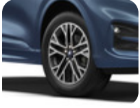
18" Alüminyum Alaşım Jant 5 x 2 kollu Y tasarımı, Cam Manyetik 7,5 x 18 ", ofset 50, 225/60 R18 lastikler için
