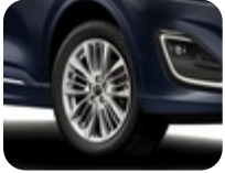
18" Alüminyum Alaşım Jant Premium, 5 x 2 kollu tasarım 7,5 x 18 ", ofset 50, 225/60 R18 lastikler için – Vignale için
