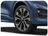
20" Alüminyum Alaşım Jant 10 kollu dizayn, İnci Siyahı 8 x 20 ", ofset 55, 245/45 R20 lastikler için
