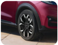
18" Alüminyum Alaşım Jant 5 x 2 kollu Y tasarımı, Absolute Black(Siyah) renginde 7 x 18", ofset 47,5, 215/50 R18 lastikler için. – ST ve ST X haricinde
