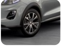
17" Alüminyum Alaşım Jant 5 x 2 kollu tasarım, Manyetik / İşlenmiş 7 x 17 ", ofset 47,5, 215/55 R17 94H lastikler için – ST ve ST X hariç
