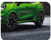
19" Alüminyum Alaşım Jant 5 kollu Y tasarımı, Manyetik İşlenmiş 8,5 x 19 ", ofset 47,5, 225/40 R19 93H lastikler için – ST ve ST X
