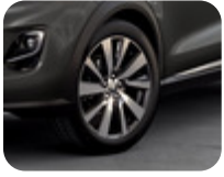
18" Alüminyum Alaşım Jant 5 x 2 kollu tasarım, İşlenmiş İnci Grisi 7 x 18 ", ofset 47,5, 215/50 R18 92H lastikler için – ST ve ST X hariç
