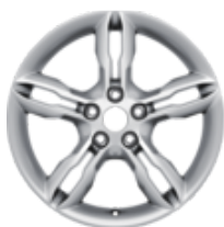
Легкосплавний колісний диск 17" 5 x 2- спиць, luster nickle 7J x 17", ET 50, для шин типорозміру 215/50R17. – Виключаючи EONetic та RS
