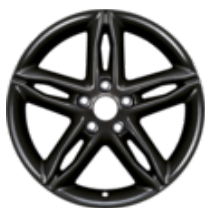
Легкосплавний колісний диск 17" 5- спиць, чорного кольору 7 x 17", ET 50, для шин типорозміру 215/50R17. – Виключаючи EONetic та HEV
