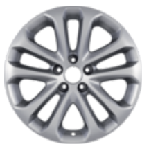
Легкосплавний колісний диск 17" 5 подвійних спиць, сріблясті 7 x 17", ET 50, для шин 215/50 R17 – За винятком EONetic та HEV
