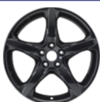
Легкосплавний колісний диск 18" 5- спиць, чорного кольору 8 x 18", ET 55, для шин типорозміром 235/40R18, встановлюється тільки з обмежувачем рульової рейки. – Виключаючи EONetic та RS
