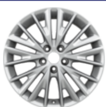
Легкосплавний колісний диск 17" 10-спиць, срібний колір 7 x 17", ET 50, для шин типорозміру 215/50R17. – Виключаючи ECONetic
