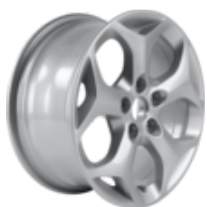
Легкосплавний колісний диск 16" 5-спицева конструкція (Y-подібна форма), сріблясті 7 x 16", ET 50, для шин 205/55 R16 і 215/55 R16
