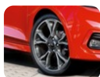
Легкосплавний колісний диск 18" 5 x 2-спицевий дизайн сріблясто темного кольору 7 x 18", ET 47,5 мм., для шин типорозміру 205/40 R18 – За винятком Active та ST
