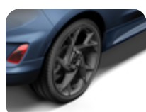
Легкосплавний колісний диск 18" Колір Matt Gun Metal 7 x 18", ET 42,5, для шин 205/40 R18 – ST-Line
