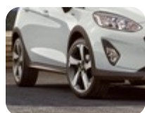
Легкосплавний колісний диск 17" 5-спицевий дизайн, Rough Metal 7 x 17 ", ET 42,5, для шин 205/45 R17 – Для Active
