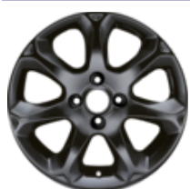
Легкосплавний колісний диск 16" 7-спицевий дизайн, Panther Black 6.5 x 16", ET 41,5, для шин 195/45 R16
