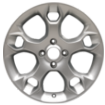
Легкосплавний колісний диск 17" 5-спицева конструкція (Y-подібна форма), сріблясті 7 x 17", ET 47,5, для шин 205/40 R17 – Лише в комбінації з ESP та обмежувачем рульової рейки
