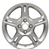
Легкосплавний колісний диск 16" 5 подвійних спиць, сріблясті 6.5 x 16", ET 41,5, для шин 195/45 R16
