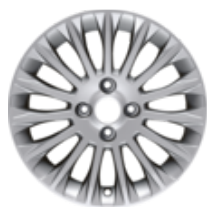
Легкосплавний колісний диск 16" 15-спицева конструкція, сріблясті 6.5 x 16", ET 41,5, для шин 195/45 R16
