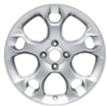
Легкосплавний колісний диск 15" 5-спицева конструкція (Y-подібна форма), сріблясті 6 x 15", ET 47,5, для шин 195/50 R15
