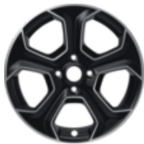
Легкосплавний колісний диск 17" 5-шпицевий дизайн, Matt Black Machined ST 200 7 x 17 ", ET 47,5, для шин 205/40 R17
