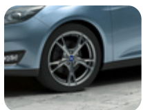
Легкосплавний колісний диск 18" 5 х 2 спицевий дизайн "Y", сріблястого кольору 8 x 18", ET 55 мм., для гуми типорозміром 235/40 R18, встановлюються тільки в комплекті з обмежувачем на рульовій рейці.
