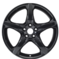
Легкосплавний колісний диск 18" 5- спиць, чорного кольору 8 x 18", ET 55, для шин типорозміром 235/40R18, встановлюється тільки з обмежувачем рульової рейки.
